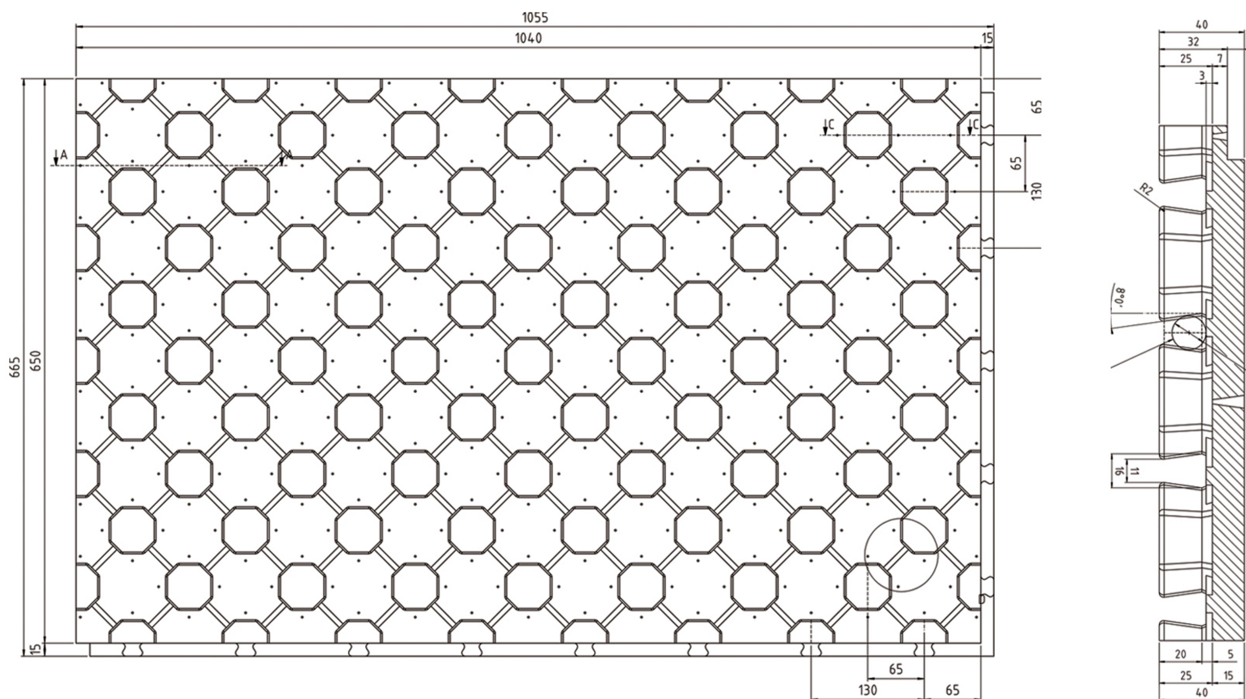
پنل گرمایش از کف ۱۰۴\*۶۵ ساخته شده توسط قالب از مواد پلی استایرین انبساطی نسوز (EPS) با مقاومت مکانیکی بالا و قابلیت اتصال به یکدیگر توسط لبه های قفل شونده مناسب برای عبور لوله های سایز (۱۶-۲۰mm) با فاصله مضربی ۶/۵ سانتیمتر می باشد.
